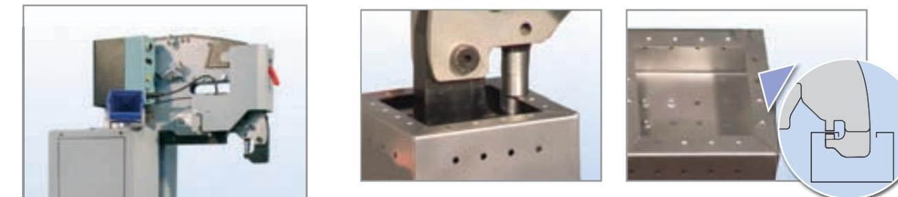
Das Zubehör Nr. 1 ermöglicht das Einpressen von Befestigungselementen in die Werkstücke mit „C“ Form.
